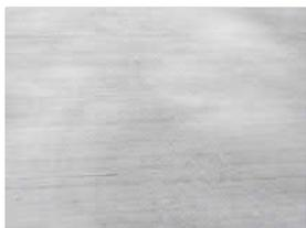
Ortbetonplatte, grau, ohne Zusatzstoffe mit aufgerauter Oberfläche
